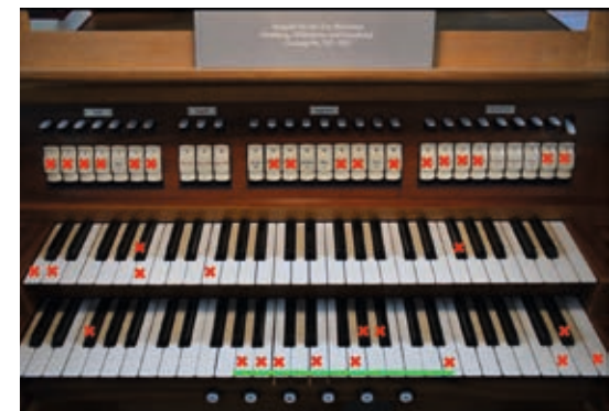
Register- und Tonausfälle sind rot markiert - von 25 klingenden Registern sind noch acht ohne Tonversager spielbar
