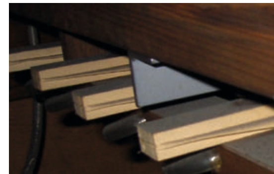
Einige der insgesamt über 2000 Pneumatik-Bälgen
